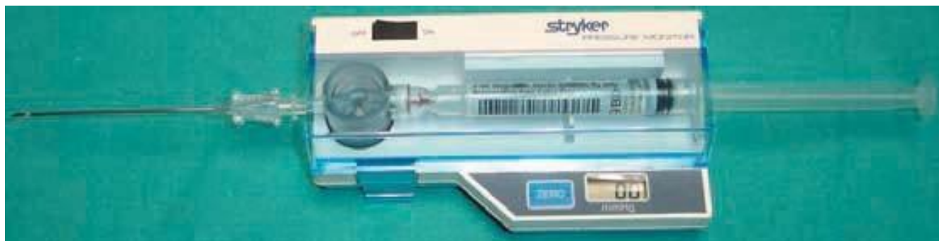
Figura 60-3. Dispositivo de vigilancia de la presión del compartimiento con despliegue digital.
